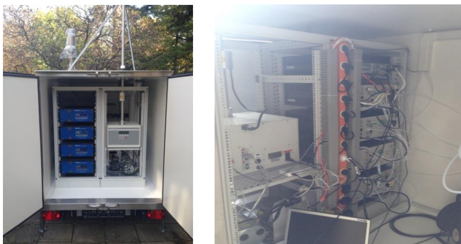
Слика 7. Аутоматска станица за мониторинг квалитета ваздуха
